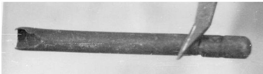
Рис. 4. Внешний вид ампулы №6 ( \sigma=196 МПа) после прокола
